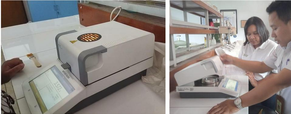
Gambar 18. Alat moisture analyzer dan pengukuran kadar air sampel simplisia
