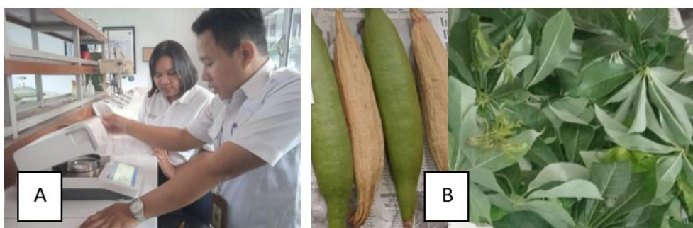
Gambar 50. Analisis simplisia A) Pengukuran kadar air simplisia dengan moisture analyzer; B) Sampel Ceiba .
